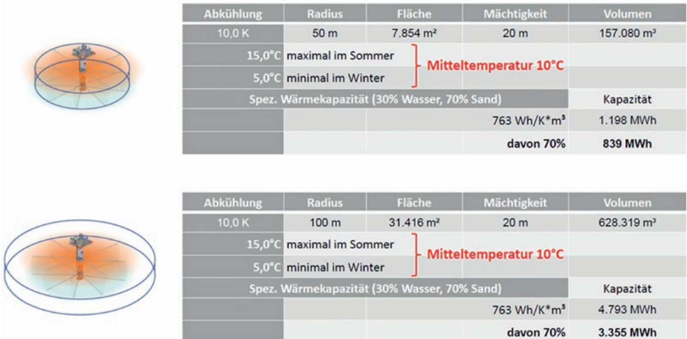
Abb. 13 Bilanz-Nachweis der geothermischen Wärmekapazität des HZBr mit und ohne Berücksichtigung des durch Anisotropie erweiterten Einflussbereichs
