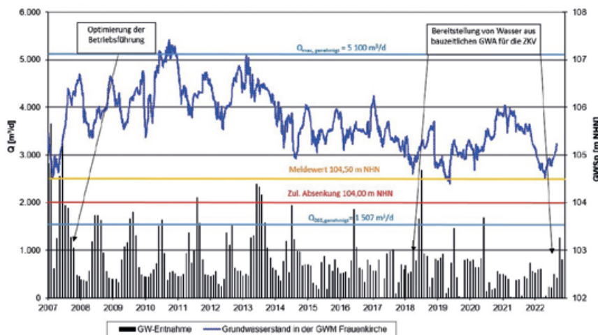
Abb. 10 Grundwasserentnahmen des HBr Kulturpalast Dresden im Zeitraum 2007 bis 2022 und Grundwasserstände im Umfeld
